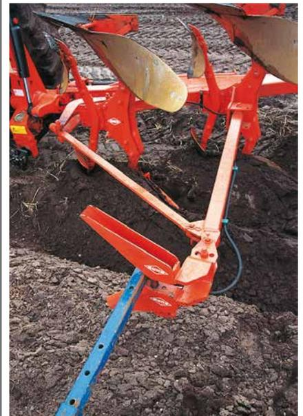
Fijado en el arado, asegura el accionamiento de los rodillos compactadores, el alzamiento y el enganche en extremo de parcela.
