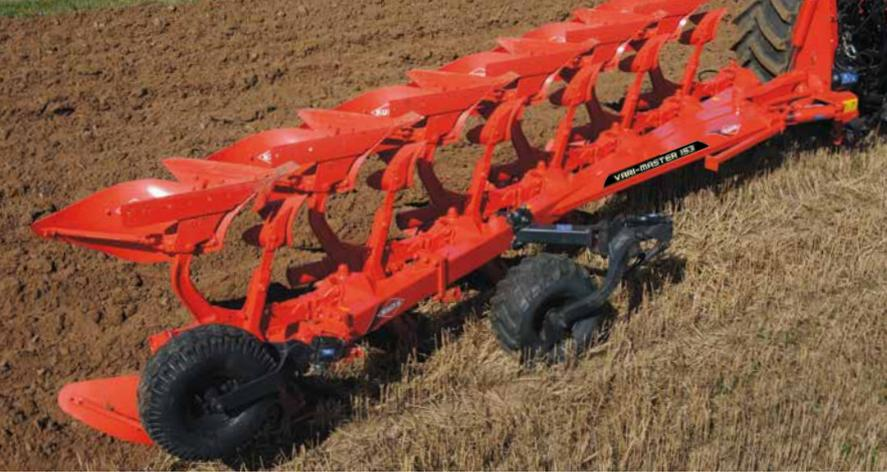
Esta rueda está equipada con un pivote vertical que le permite seguir las variaciones de la anchura de corte. Se caracteriza por la sencillez y la precisión de sus ajustes:
