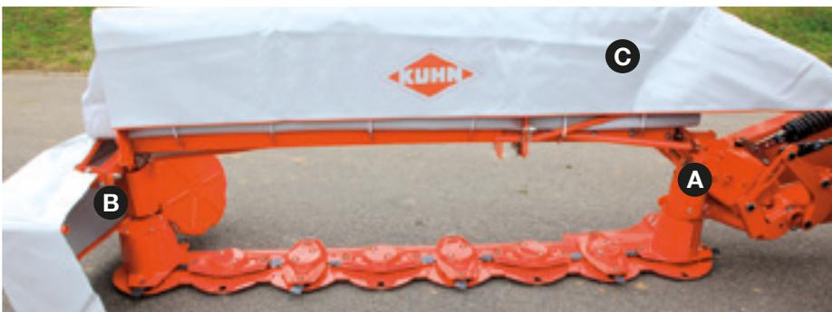
Estas segadoras GMD têm um novo sistema de acionamento direto **(A)** da barra de corte que passa pelo primeiro disco. Com uma folga elevada, a forragem flui suavemente através da traseira da máquina, especialmente em parcelas irregulares e ao cortar a faixa novamente. Uma ligação externa **(B)** conecta a barra de corte à proteção para fornecer a resistência necessária para operações intensivas. A barra de corte é acessível através de uma abertura dupla na cortina.
