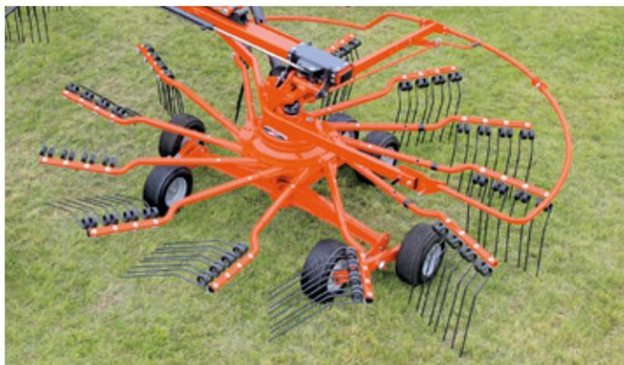
O eixo tandem opcional sob o rotor, com 6 rodas próximas aos garfos, garante um contorno otimizado do solo.
