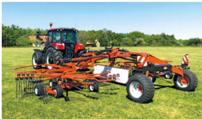
Aproveite a lona hidráulica da leira, indexada à elevação do rotor.
