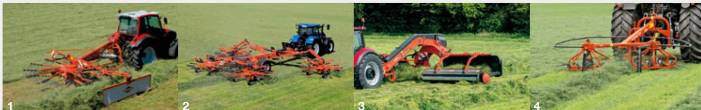
1. Rotor único montado - 2. Enleirador com 4 rotores - 3. Enleirador com esteiras - 4. Espalhador/enleirador combinado
