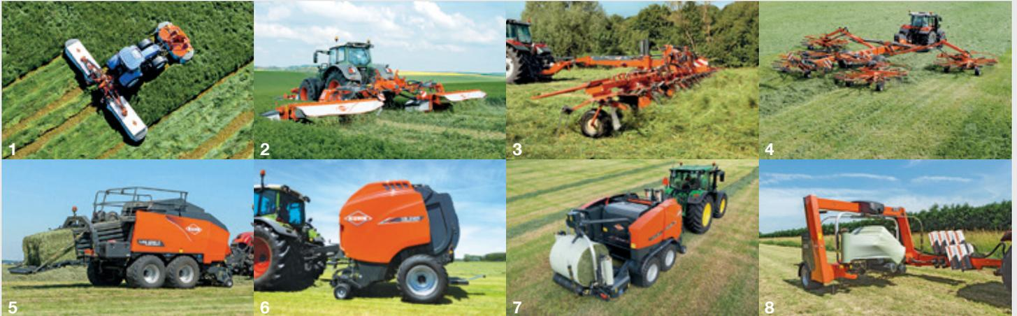
1. Segadora triple - 2. Segadora acondicionadora triple - 3. Henficador de gran anchura - 4. Hilerador de 4 rotores - 5. Empacadora de alta densidad - 6. Empacadora de pacas redondas - 7. Máquina combinada empacadora-encintadora - 8. Encintadora.
