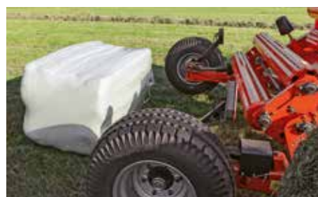
A baixa altura da mesa permite que o fardo seja delicadamente inclinado para prevenir danos ao plástico
