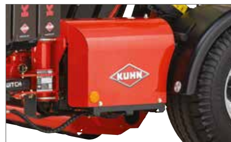
Uma grande tampa lateral protegendo a unidade hidráulica fornece fácil acessibilidade para a manutenção da máquina
