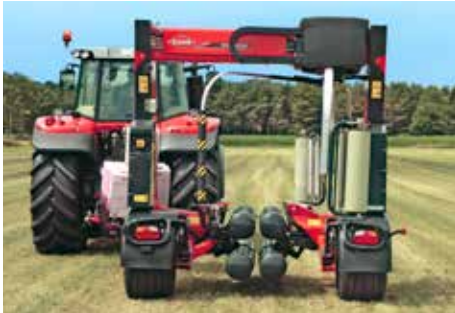
A empacotadora desdobra de sua posição de transporte de 2,5 m para sua posição de terreno de 4 m
