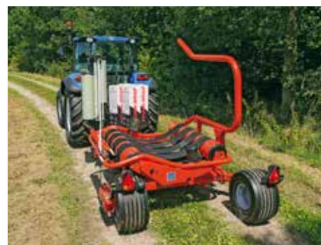
Largura de transporte reduzida devido às posições ajustáveis da roda
