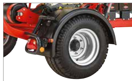
Grandes guardas de proteção contra lama evitam que o plástico seja danificado durante o transporte
