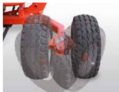
A roda direita pode ser dobrada para dentro manualmente para transporte em estrada. O lado esquerdo é opcional
