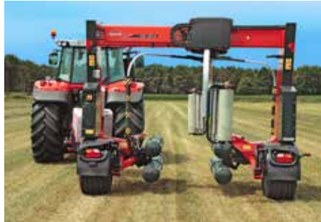
A empacotadora desdobra de sua posição de transporte de 2,5 m para sua posição de terreno de 4 m
