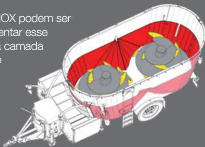
Seja qual for solução que você escolher, há sempre a possibilidade de escolher as facas de sem-fim revestidas de carboneto que permitem um corte calibrado e eficaz duradouro.
