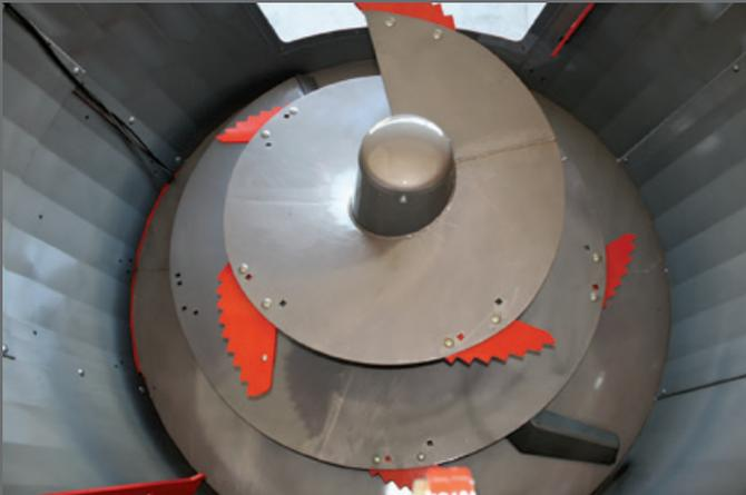
Todos os sem-fins (bobinas e cones do sem-fim) são feitos de K-NOX fornecendo proteção para toda a unidade. O sem-fim é mais resistente à abrasão das forragens e à acidez dos fluidos de silagem.
