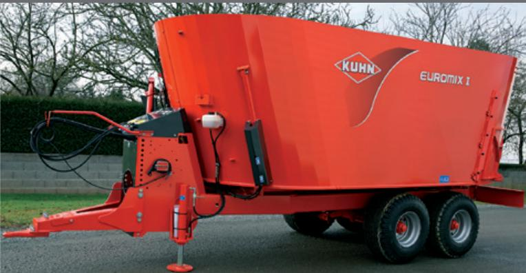
Começando, com os modelos com capacidade de 16 m<sup>3</sup> a linha EUROMIX de dois sem-fins verticais é perfeitamente adequado para fazendas com galpões de baixa altura e satisfará as necessidades dos agricultores com necessidade de grandes capacidades com modelos acima de 22 m<sup>3</sup>.
