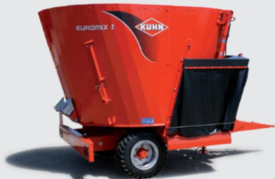
Os modelos EUROMIX I de 8, 10 e 12 m<sup>3</sup> vem com um sem-fim vertical, fornecendo rações misturadas para todos os tipos de fazendas. A forma do vagão e o design do sem-fim foram especialmente estudados para garantir a melhor circulação dos produtos na máquina: garantia de uma mistura homogênea. As contra-facas articuladas em sua parte superior apresentam uma superfície de trabalho importante para corte.
