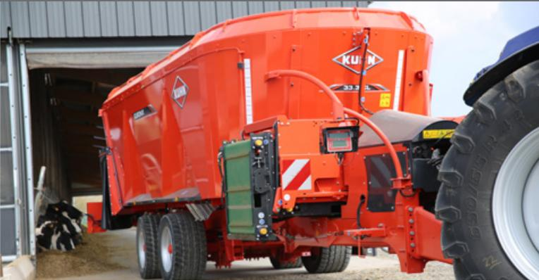
Disponível com as capacidades 28, 33, 39 e 45 m<sup>3</sup>, a linha industrial EUROMIX com três sem-fins verticais apresentam as dimensões previstas. Os modelos de 28 m<sup>3</sup> apresentam uma altura total a partir de 2,74 m e são capazes de passar pelos galpões de baixa altura.
