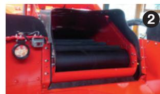
El transportador deposita el flujo de forraje cargado en el sentido de rotación de los sinfines de mezcla (3). ¡La capacidad de mezcla no disminuye el rendimiento del desensilado!
