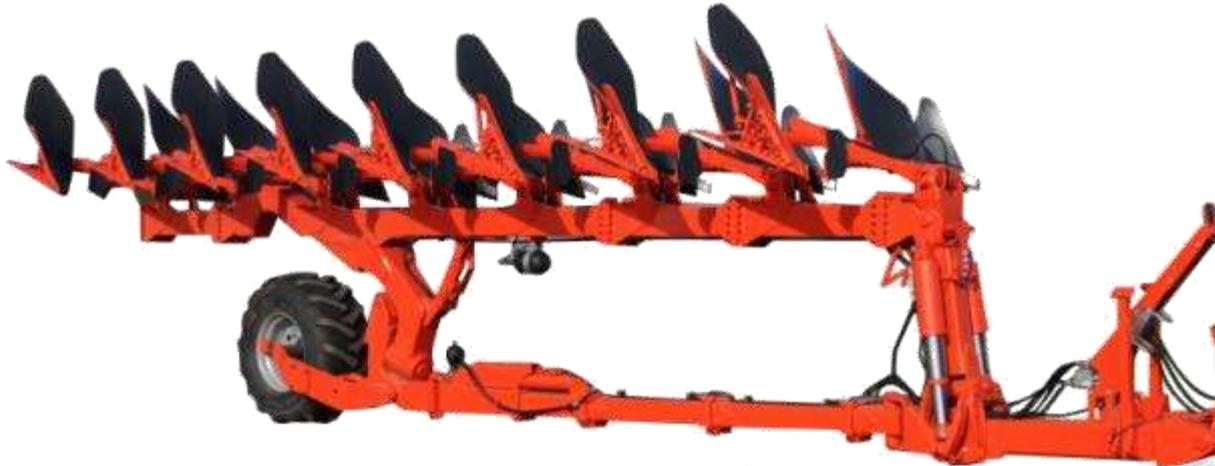
Puissance de traction admissible : **45 ch/corps**
