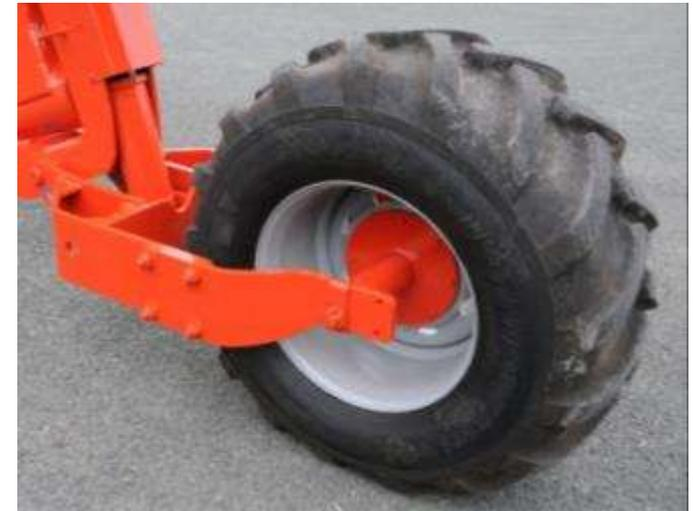
**Des roues de grande dimension pour un roulement facilité et une bonne portance**
