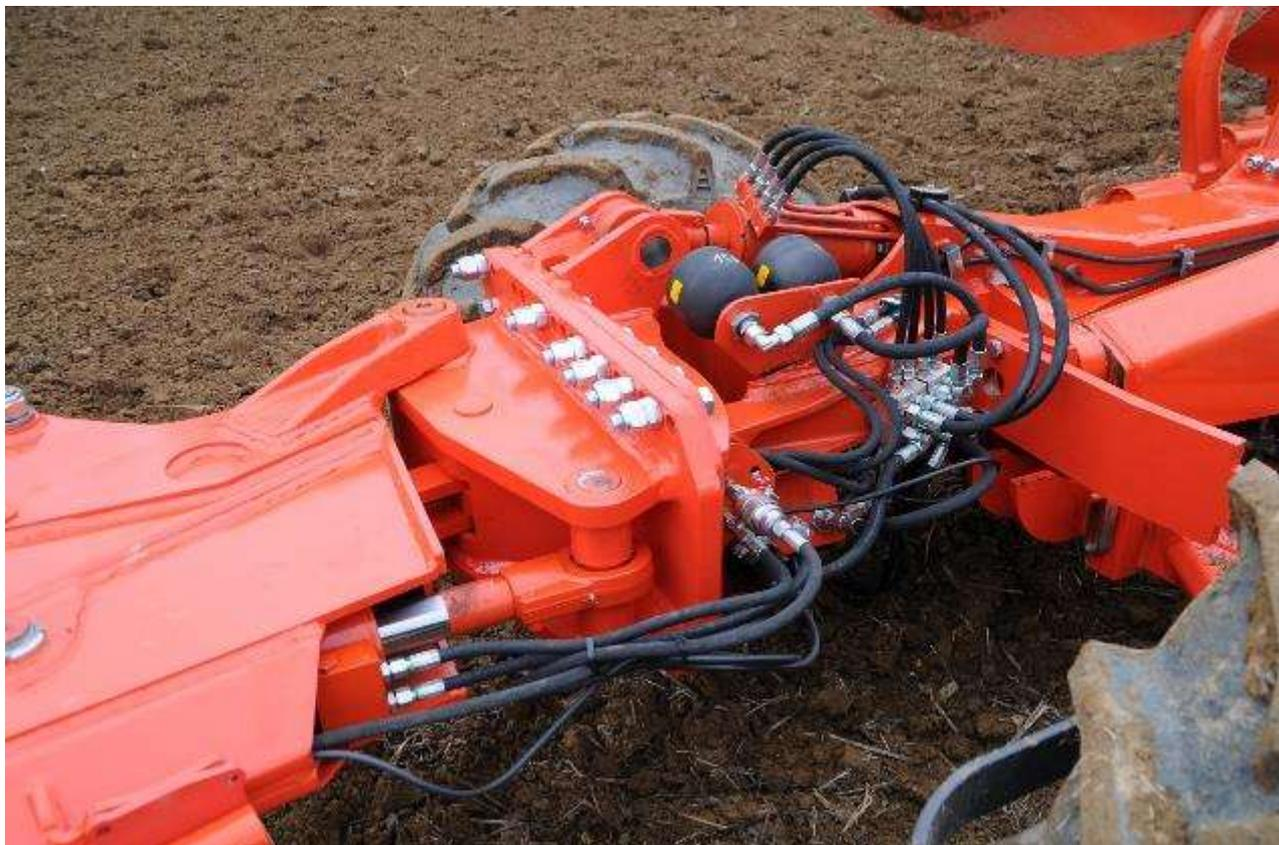
**Possibilité de démonter la partie arrière pour travail en condition difficile uniquement avec la partie avant**
