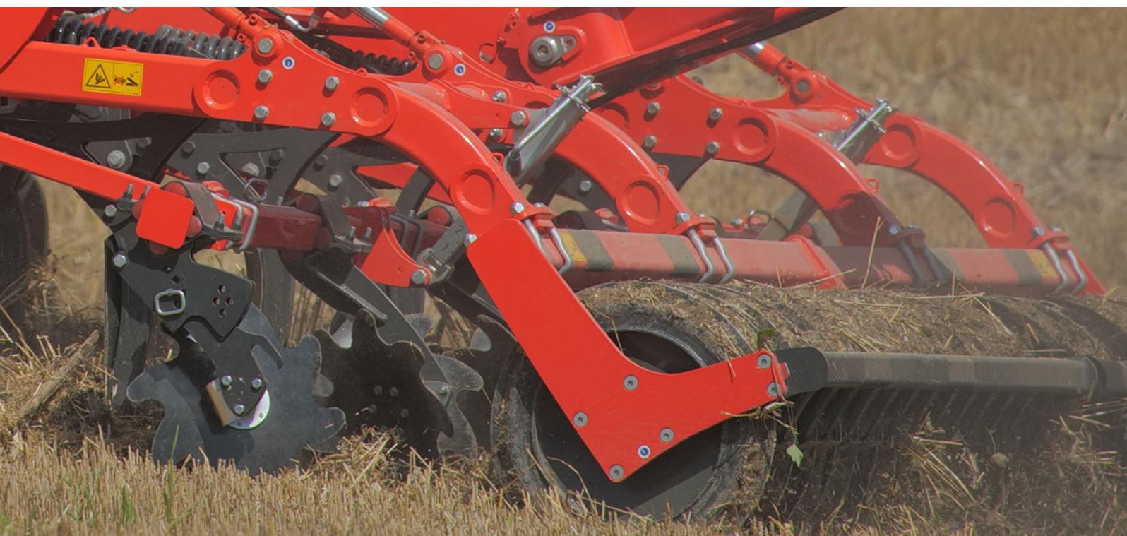
El ajuste de los órganos de nivelación es centralizado mediante una manivela. Los elementos de los bordes, ajustables lateralmente, permiten realizar unos empalmes perfectos.
