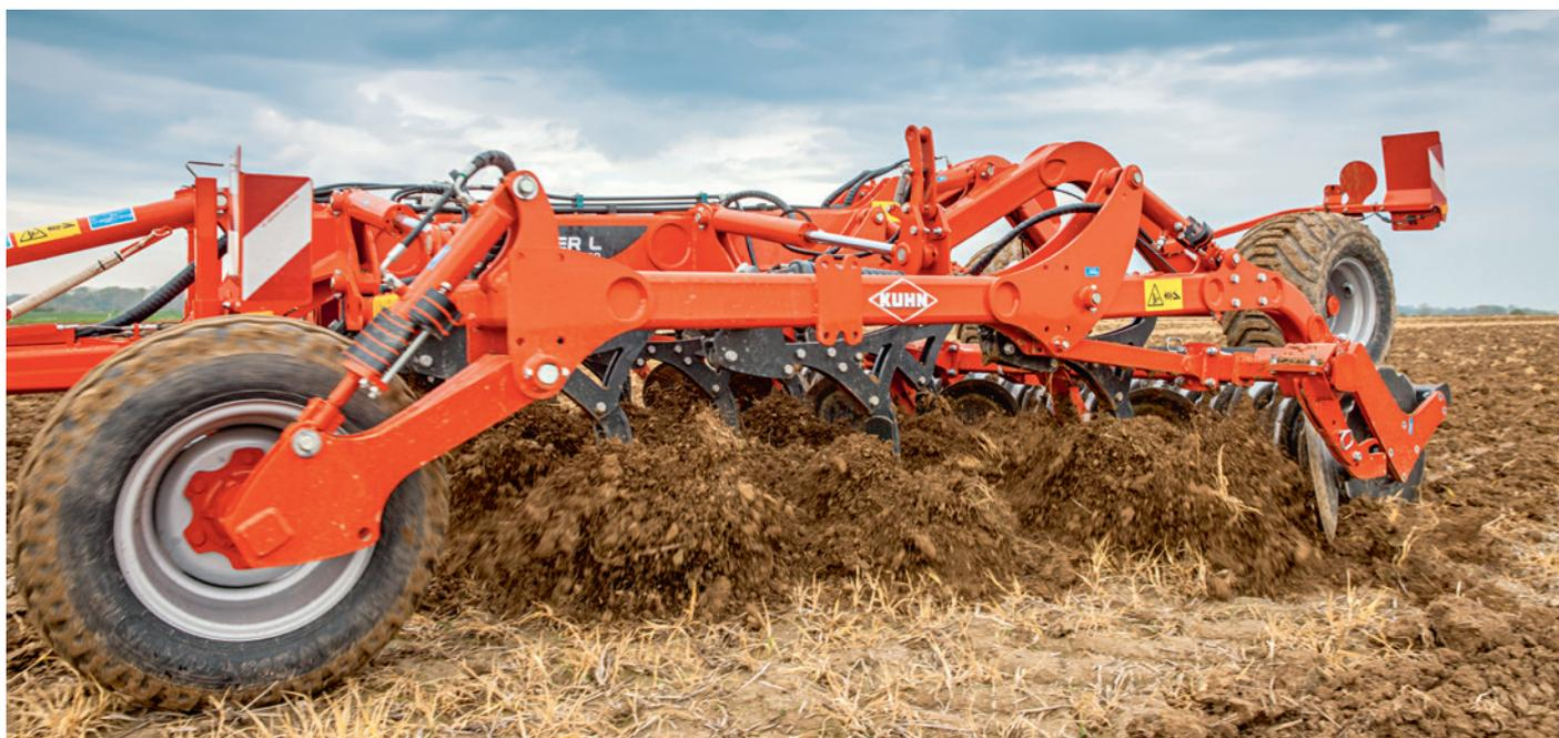
Un despeje bajo el bastidor de 85 cm permite trabajar en presencia de grandes cantidades de residuos. El considerable despeje de los dientes en cada línea y entre las líneas reduce cualquier riesgo de atascos. La posición óptima de los dientes cada 30 cm en el CULTIMER L (43 cm en el CULTIMER M) favorece el buen comportamiento de la máquina frente a los residuos, incluso a velocidades elevadas.
