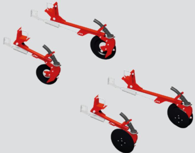
**La sembradora neumática integrada VENTA serie 1020** está equipada con una barra de siembra de discos dobles, para una siembra eficaz en presencia de residuos vegetales en cantidad importante. Fiable y polivalente, este modelo está diseñado para sembrar en condiciones difíciles. La presión de los discos sobre el suelo alcanza los 35 kg: la garantía de una profundidad de siembra regular incluso en tierras heterogéneas.
