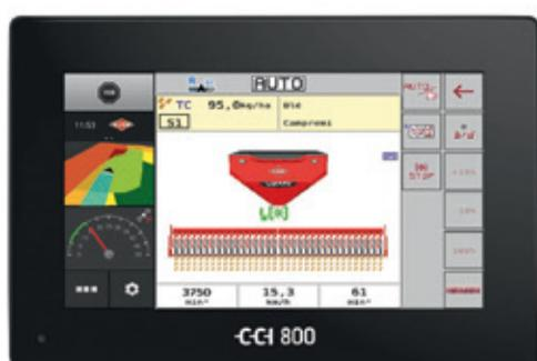
La pantalla de 8 pulgadas/20,3 cm permite visualizar la máquina principal y vistas en miniatura en el lateral. Haz clic en la vista en miniatura para mostrarla en grande.
