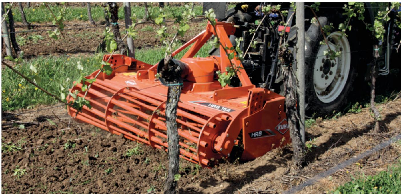
Un rodillo de JAULA de gran diámetro y sin mantenimiento permite compactar el suelo de manera adecuada, regulando eficazmente la profundidad de trabajo. La grada rotativa HRB 202 puede equiparse asimismo con un rodillo PK2 (515 mm de diámetro).
