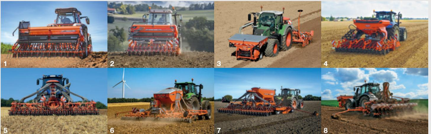
1. Mecánicas suspendidas - 2. Mecánicas integradas - 3. Con tolva frontal - 4. Integradas neumáticas - 5. Arrastradas neumáticas - 6. Suspendidas para siembra simplificada - 7. Arrastradas para siembra simplificada - 8. Monograno
