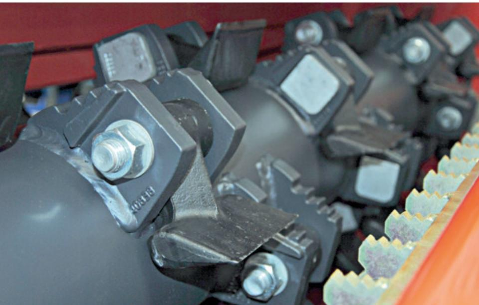
Este rotor (457 mm de diámetro) es único. Está equipado de martillos pesados de 1,65 kg montados sobre soportes reforzados de 25 mm y puede alcanzar una velocidad de 3.100 min<sup>-1</sup>.
