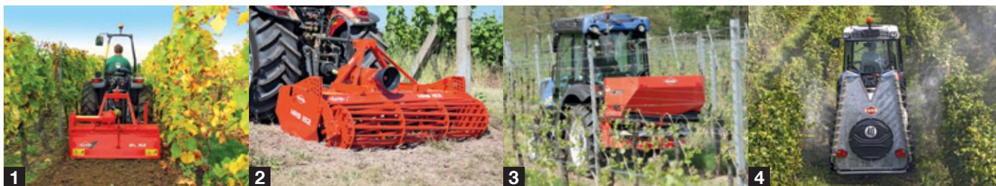
1. Fresadora rotativa – 2. Grada rotativa – 3. Abonadora – 4. Atomizador
