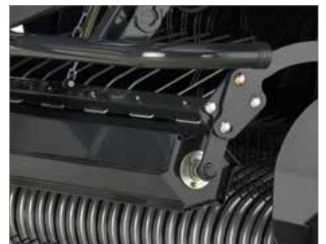
4. Resistente rolo de cultura com protetor de vento (Ø 217 mm)
