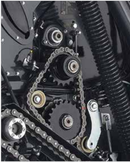
1. O segundo rolo de acionamento da correia garante um acionamento seguro da correia em todas as condições culturais
