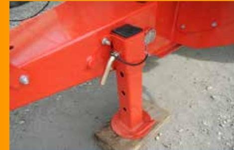
Pata abatible de tipo pasador para un desacoplamiento más rápido de la máquina.
