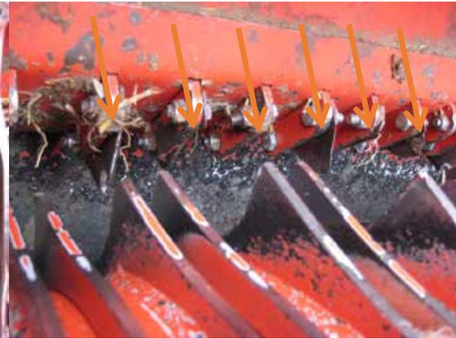
Roturas y rápido desgaste de las cuchillas => requiere un mantenimiento muy caro y gasto en repuestos. La calidad del corte se ve afectada directamente.
