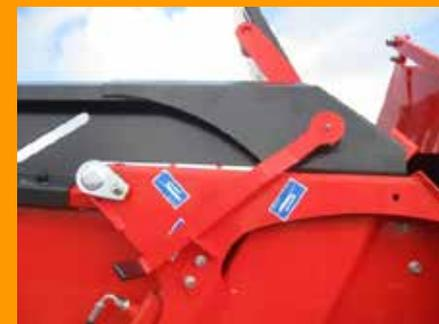
Palanca de bloqueo en la posición alta para facilitar la carga superior.
