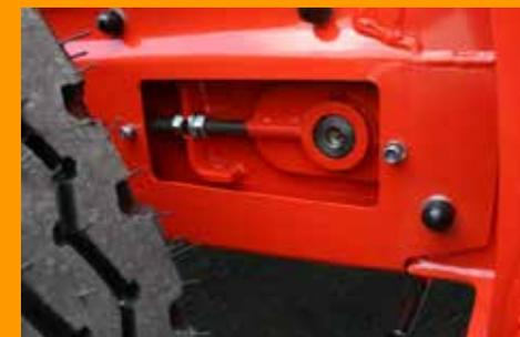
El sistema de la cinta transportadora está integrado dentro del cuerpo è ¡protegido de la suciedad!
