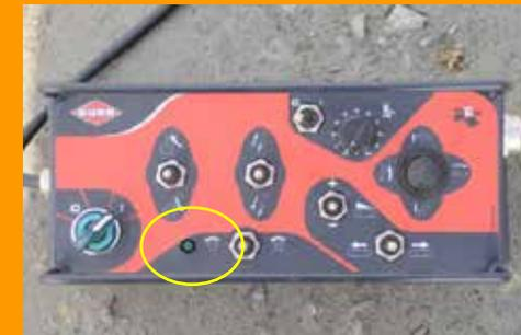
Una luz en el panel de control indica que el rotor picador está activado. ¡Puedes activar la cinta transportadora con total seguridad!
