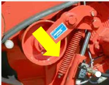
1. Activación de la T.D.F. è activación de la turbina
