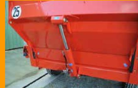
Cilindro de elevación centrado con una capacidad de elevación de **¡1.2 toneladas!**
