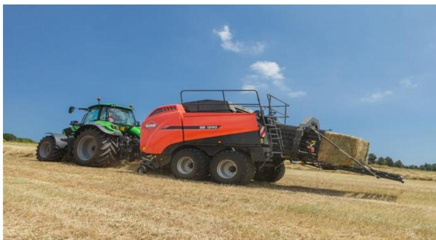
A gama de enfardadeiras LSB - SB da Kuhn disponíveis com 5 modelos diferentes de máquina, que formam até 4 dimensões distintas de fardos: **LSB 870** e **SB 890** fardos de 80x70 e 80x90 respectivamente, o modelo **SB 1270 X** com dimensões de 120x70 cm, por último, as **SB 1290 X** e **SB 1290 iD** com dimensões de fardo de 120x90 cm.
